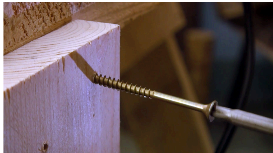
parafuso 4,5 x 50 mm para estruturar as pernas da mesa
