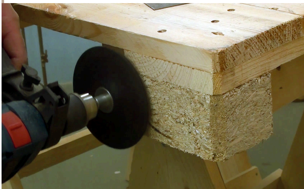
Ajuste da base da estrutura para colocação das pernas da mesa
