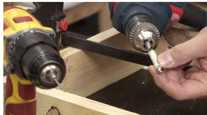
broca guia na parafusadeira e broca para escariar os furos
