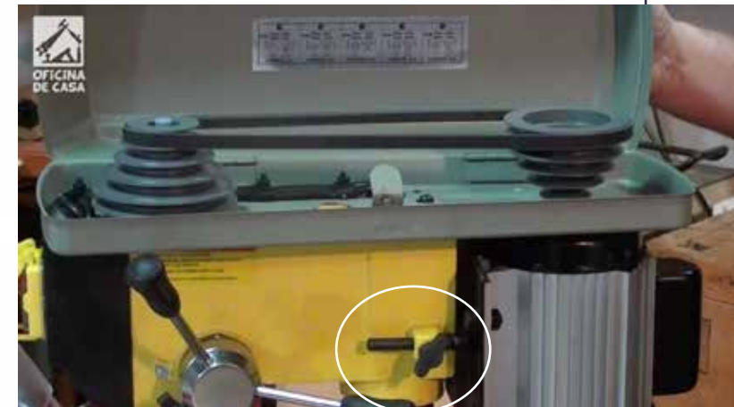
Imagem das Polias, onde se regula a velocidade da furação. Existe um botão ao lado do motor para soltar o mesmo para afrouxar as polias, assim a troca é feita e o motor volta ao lugar.
