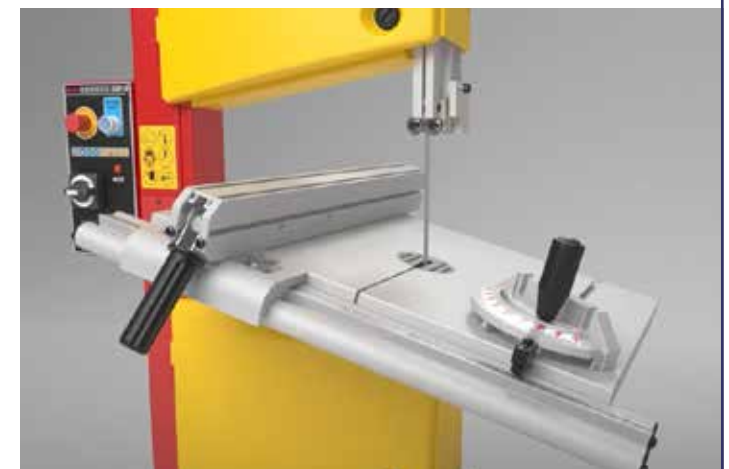
Acima, uma maneira mais tranquila de fazer curvas, criando cortes perpendiculares, assim a cada pedaço que se solta facilita a curva, sem pressionar a lâmina. Abaixo a inclinação da base para corte em ângulo
