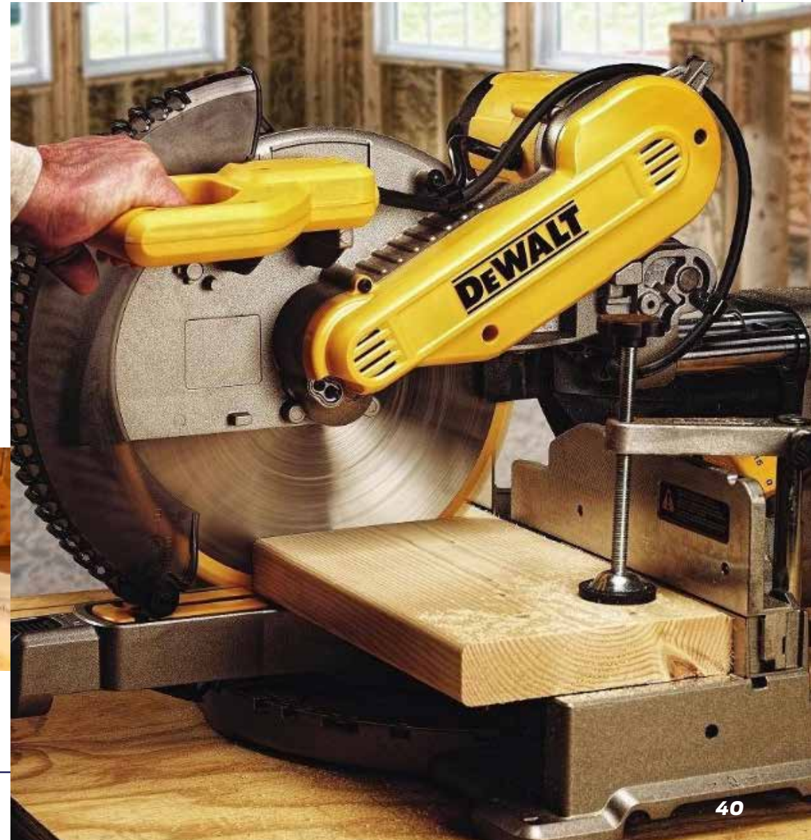
Inclinação do Braço para ambos os lados, mais facilidade na hora do corte em ângulo
