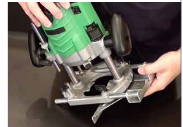
Tupa de coluna, que parece um robô, sua principal característica é o mergulho
