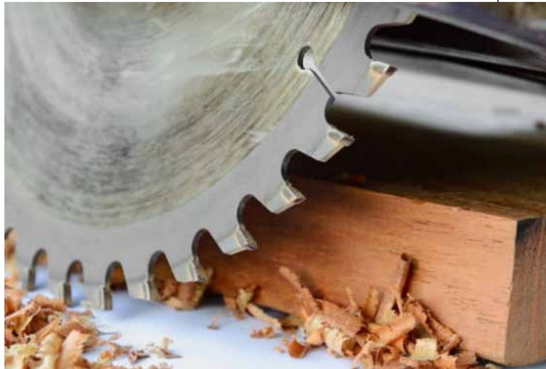
Discos para laminados e os multimateriais possuem dentes com desenhos diferentes. Abaixo para MDF laminados e ao lado multimateriais.
