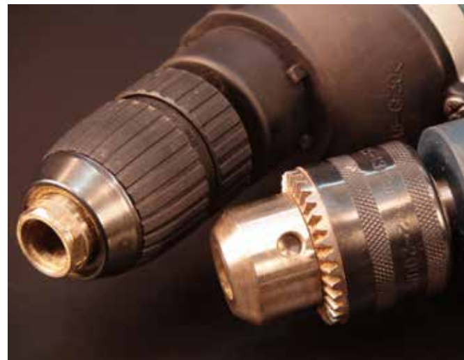
Exemplos de mandris: Da esquerda é um mandril padrão de aperto com a chave e da direita é um mandril de aperto com as mãos, chamado de aperto rápido, como o usado para as parafusadeiras à bateria.
