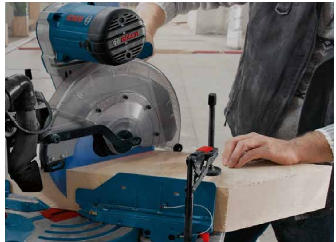
Acima, veja a diferença da base, faixa azul, em relação a medida de corte. E ao lado a espessura com um disco de 12"
