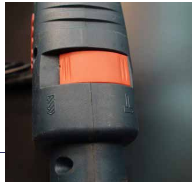
Impacto ou martetele com desenho do martelo e furo comum com desenho da broca.
