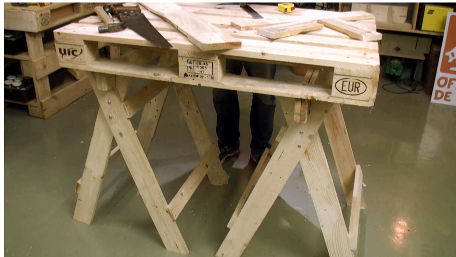
Cavaletes feitos com palete e um outro apoiado por cima, opção de mesa de trabalho
